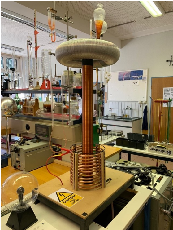
Le transformateur Tesla « maison »
